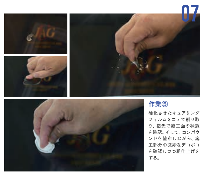
作業完了 そして最後に、周辺のガラス部分をキズつけないよう細心の注意を払いながら、施工部分を完璧にしながらしていく。下の写真は、車内からじっくり目を凝らして施工部分を見たときの状態を、マクロ撮影で再現したもの。肉眼ではほとんど気にならない。
