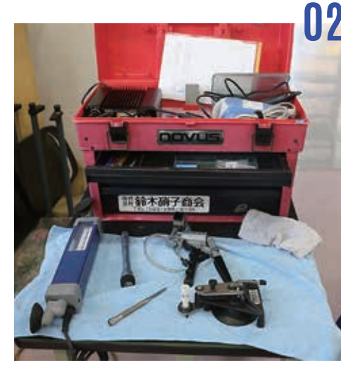
使用する道具 写真左から時計回りにUVランプ、LEDライト、バキュームポンプ、フィクチャー、ニードル。これだけ見せられたら、何に使うのか想像がつかないものばかり。しかも、施工する職人の腕の差が顕著な世界だ。
