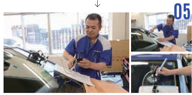
作業③ キズにレジ液剤を注入していく。バキュームポンプで注入圧を調整しながら、キズの最先端までしっかりとレジ液剤が浸透するように、慎重に注入していく。
