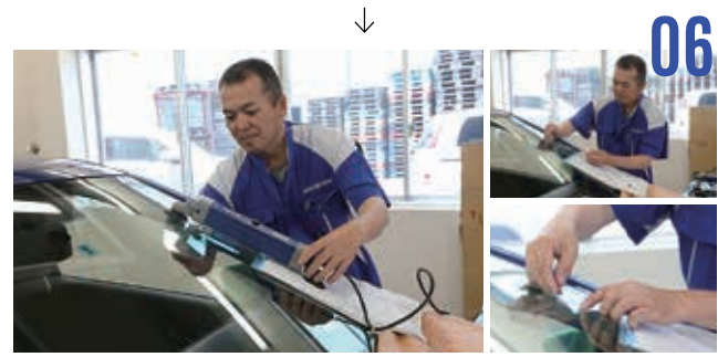
作業④ 先に注入したレジ液剤が「キズを埋める」タイプならば、このピットレジンは「キズをしっかりと塞ぐ」ためのもの。キュアリングフィルムを施工部分に貼った上からUVランプを当てて、完全に硬化させる。
