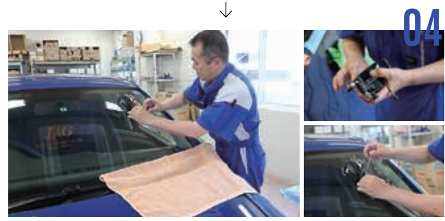
作業② 施工する部分を確定し、その部分にフィクチャーを固定していく。このフィクチャーがこの後のガラスリペアの作業ベースになる。ちなみに固定具は吸盤なので、ガラス面はキズつかない。
